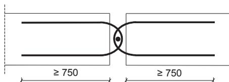
Bild: Vertikale Stoßfuge in Wandebene bei Brandwänden
