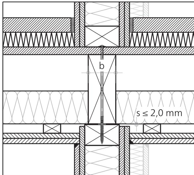
Abbildung 8: Trennwand-Deckenanschlüsse Holztafelbau mit Spaltmaß  $s \leq 2,0$  mm
