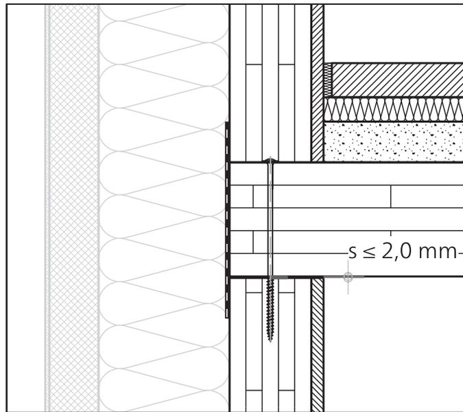
Abbildung 15: Außenwand-Deckenanschlüsse Massivholzbau mit Spaltmaß  $s \leq 2,0$  mm
