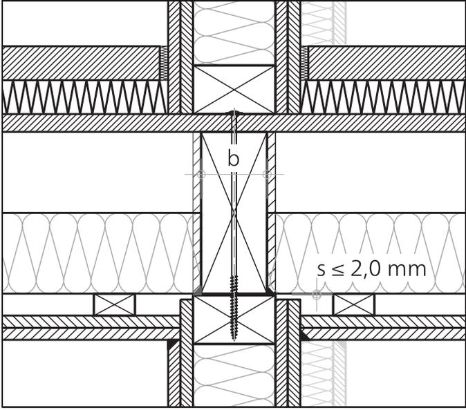
Abbildung 9: Trennwand-Deckenanschluss Holztafelbau mit Spaltmaß  $s \leq 2,0$  mm
