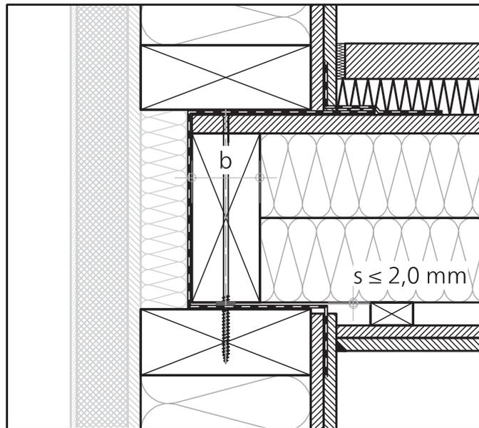
Abbildung 7: Außenwand-Deckenanschlüsse Holztafelbau mit Spaltmaß  $s \leq 2,0$  mm
