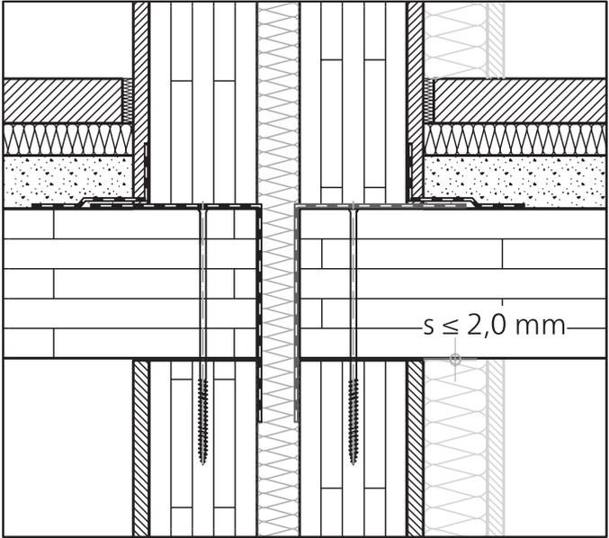
Abbildung 19: Trennwand-Deckenanschluss Massivholzbau mit Spaltmaß  $s \leq 2,0$  mm
