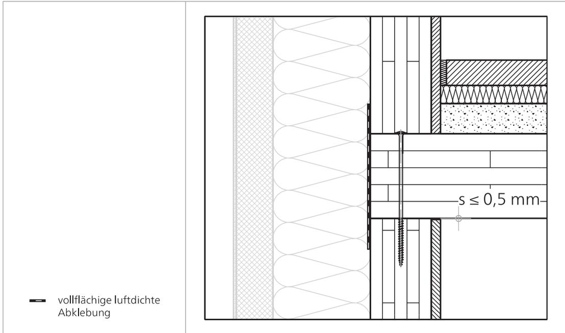
Abbildung 13: Außenwand-Deckenanschluss Massivholzbau mit Spaltmaß  $s \leq 0,5$  mm
