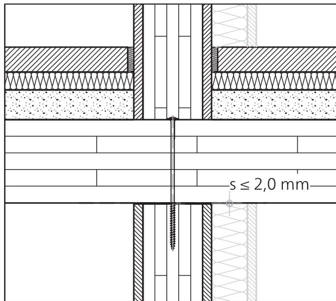
Abbildung 16: Trennwand-Deckenanschlüsse Massivholzbau mit Spaltmaß  $s \leq 2,0 \text{ mm}$
