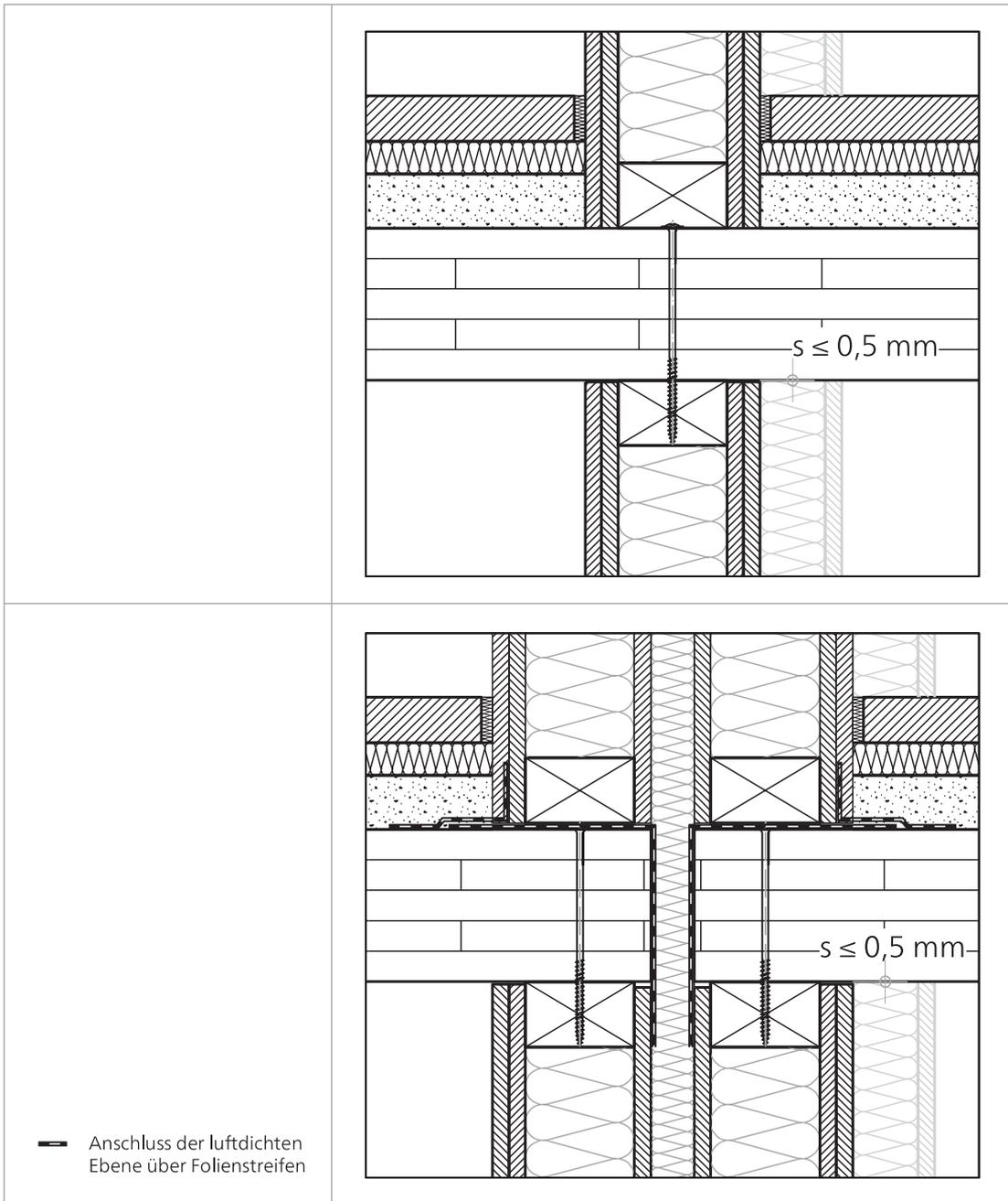
Abbildung 27: Trennwand-Deckenanschlüsse Holztafelbau / Massivholzbau mit Spaltmaß  $s \leq 0,5 \text{ mm}$
